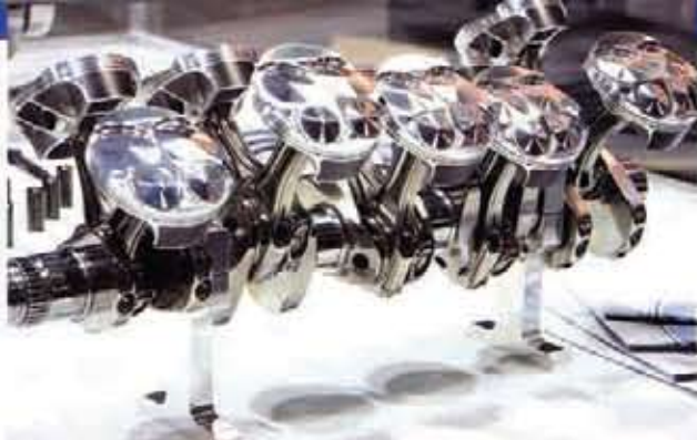
●JEのブースに飾られていたV型10気筒のクランクとピストンと金コネクティングロッド。って、どんなエンジン?と考えると、こりゃF1エンジンの心臓部か。
